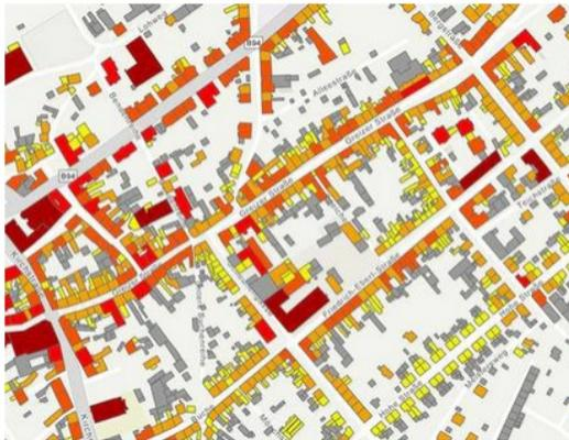
Mit dem Thüringer Wärmekataster unterstützt die ThEGA im Auftrag des Thüringer Energieministeriums Kommunen und deren Planungsbüros bei der Datenrecherche für die kommunale Wärmeplanung. Das Wärmekataster liefert Daten zum Wärmebedarf aller beheizten Gebäude in Thüringen.
