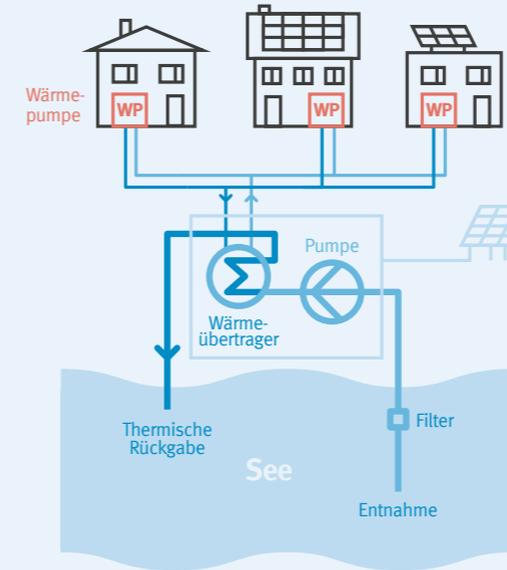
Bei den direkten Systemen befindet sich der Wärmeübertrager im Gewässer. Hierfür eignen sich insbesondere Fließgewässer. Im Gegensatz dazu kommen in Seen eher indirekte Systeme zum Einsatz. Dabei wird das Wasser aus dem See gepumpt und an einen Wärmeübertrager abgegeben. Das abgekühlte Wasser wird dann wieder zurückgeführt.
