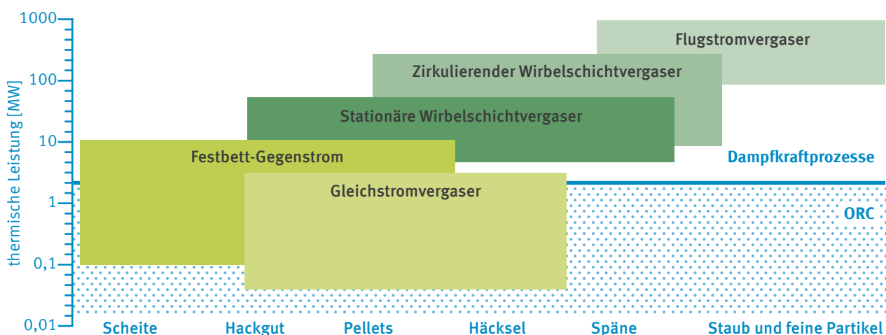
Abbildung 9: Übersicht über die Vergasertechnologien in Abhängigkeit des Brennstoffs und der Anlagengröße; Quelle: IBKE [10]
