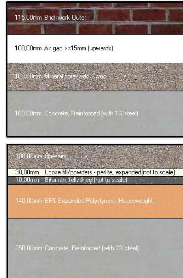
Bild 1:Aufbau Außenwand und Dach
