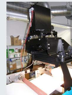
Montage der NIR-Kamera an einer Pilotanlage im TITV.
