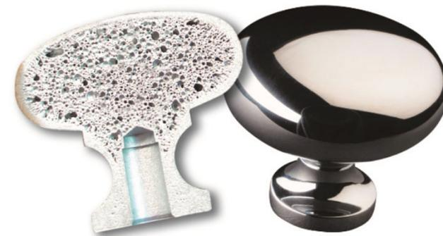
*Zincopor® verringert das Gesamtgewicht eines Bauteils, hier z. B. eines Türgriffs, um bis zu 50 %. (© HZD)*
